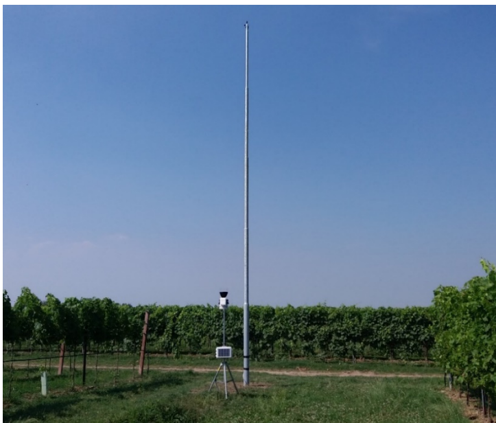
Fig.10b Installazione completata, stazione meteorologica dotata dei sensori di temperatura, umidità, precipitazione, direzione e intensità del vento, bagnatura fogliare, temperatura e umidità del terreno.
